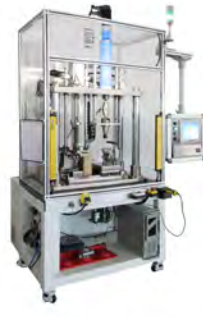
壳体蜗杆合成台 Shell worm assembling
