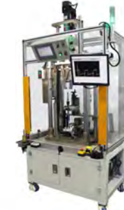
上转向轴滑移力检测台 Upper steering shaft testing
