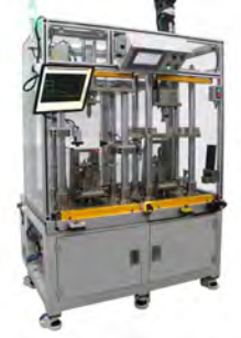
上转向轴总成、 上柱管分总成合成台 Upper steering shaft、 Upper pipe sub-assembling
