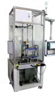
电机、ECU装配台 Motor and ECU assembling
