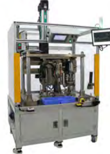
上转向轴组件装配台 Upper steering shaft assembling
