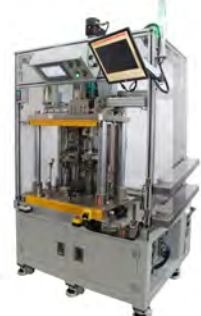
上下柱管分总成装配台 Upper and lower pipe assembling
